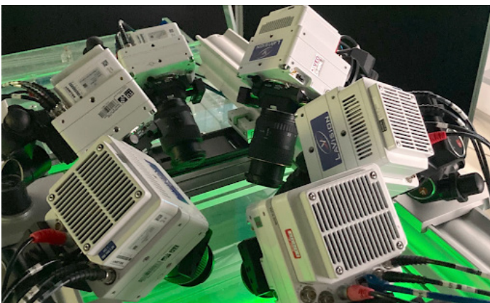
3. 六台以不同角度排列的摄像机捕捉流经由激光照明的通道内的微塑料纤维。
