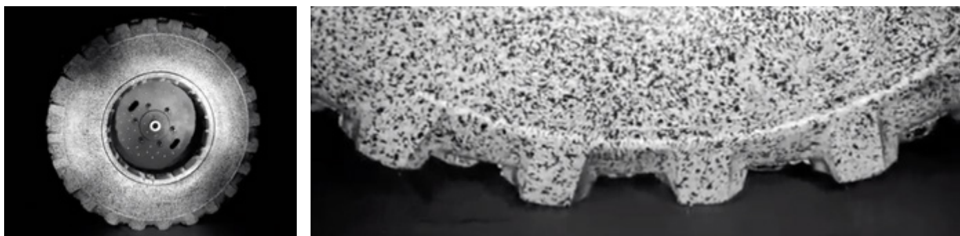
DIC 利用绘制在物体表面上的散斑图案，在高速拍摄过程中为摄像机提供焦点。
