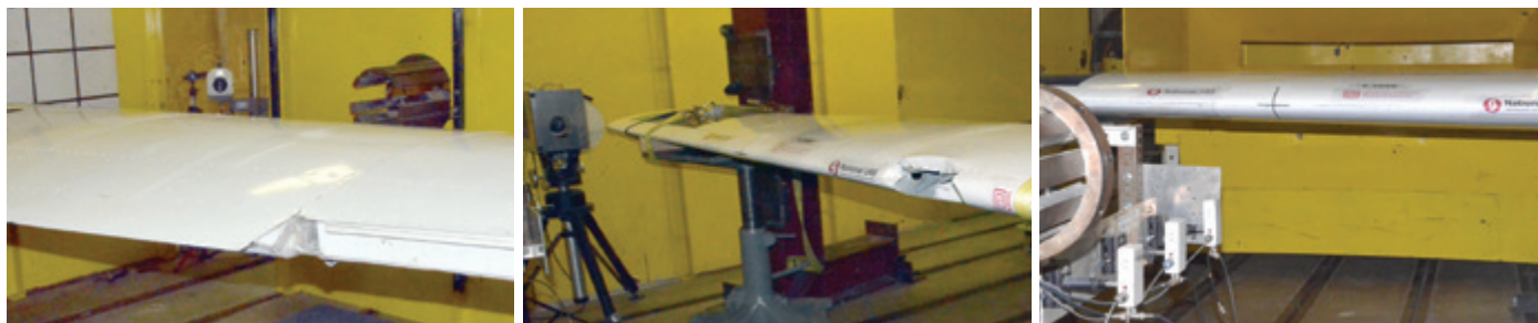
捕捉模拟碰撞的是位于机翼顶部和两侧的三台 Phantom v2012 高速摄像机。
