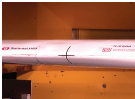
弹道学小组以 238 英里/小时的速度向飞机机翼发射了一架无人机，用以模拟空中碰撞。
