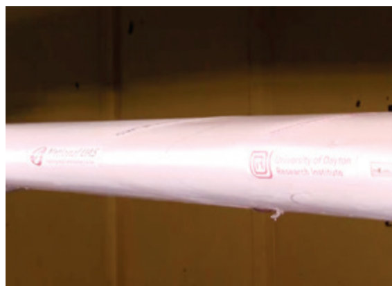
弹道学小组以 238 英里/小时的速度向飞机机翼发射了一架无人机，用以模拟空中碰撞。
