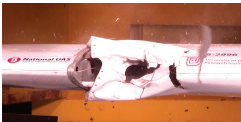
弹道学小组以 238 英里/小时的速度向飞机机翼发射了一架无人机，用以模拟空中碰撞。
