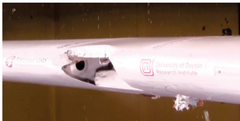
弹道学小组以 238 英里/小时的速度向飞机机翼发射了一架无人机，用以模拟空中碰撞。
