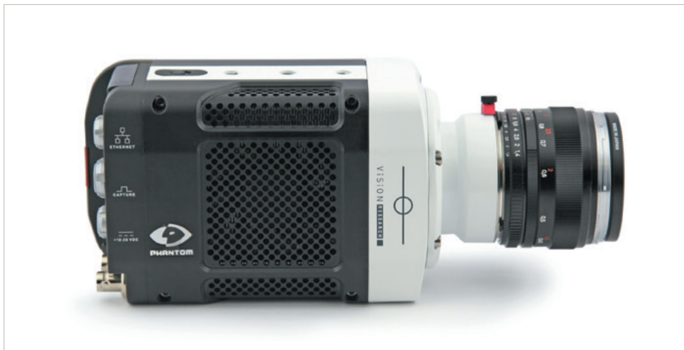
强大、轻巧的 Phantom Miro 310 是一款 100 万像素的摄像机，吞吐量为 3.2 千兆像素/秒，在全 1280 x 800 分辨率下速度可超过 3,200 fps。
