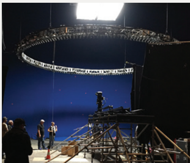
Satellite Lab团队对照明阵列进行了编程，使每个连续闪光灯都能同步到 Phantom 摄像机的连续帧上。
