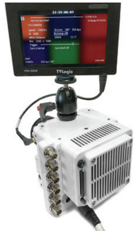
带显示器和 CFast 2.0 卡的 Phantom VEO-S, 显示了机身控制菜单
