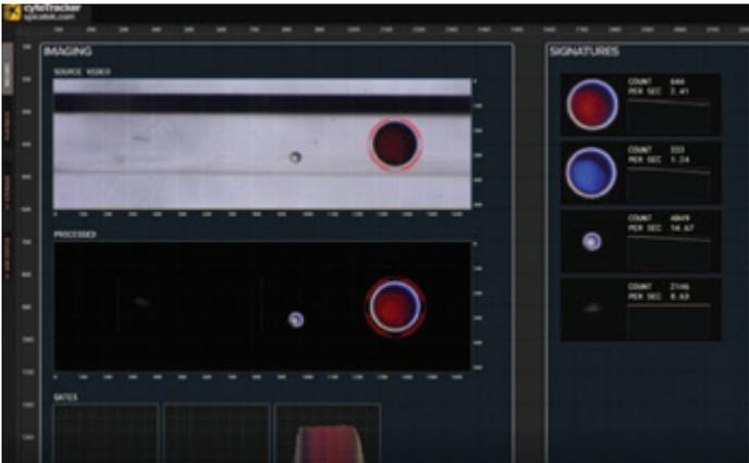
图 3. cytoTracker GUI 示例, 它用于控制摄像机, 查看实时结果, 并处理图像数据。
